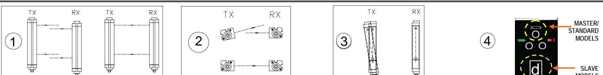
Posizionare l'asse ottico del primo e dell'ultimo raggio dell'Emissore sullo stesso asse di quello dei corrispondenti raggi sul Ricevitore.
